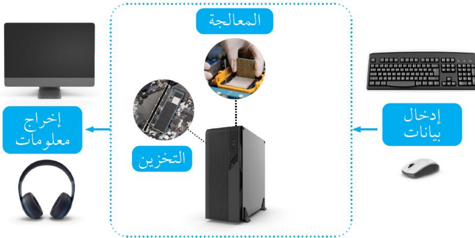
الشكل (1-1): رسم توضيحي لمبدأ عمل جهاز الحاسوب.
